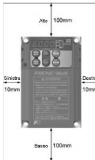
Figura 3.1 Direzione di montaggio e distanze richieste
