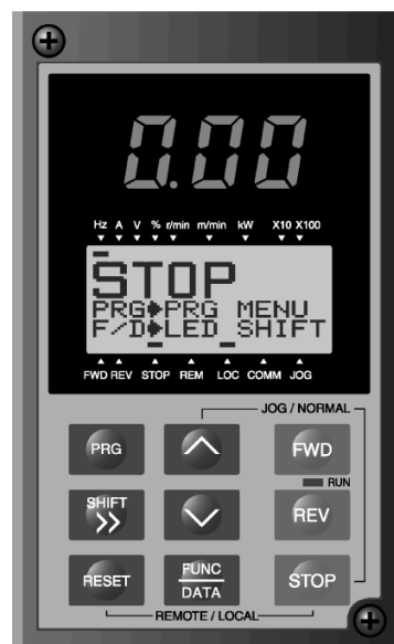
Figure 3-1-2 Display pannello di comando all'accensione
