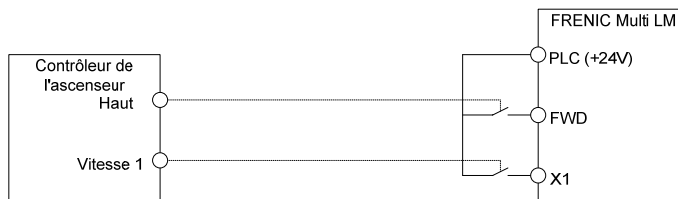
Illustration 4.8 Connexion normale utilisant les contacts libres de potentiel du contrôleur de l'ascenseur
