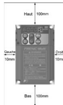
Figure 3.1 Instructions de montage et distances d'isolement requises
