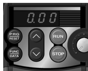
Fig. 4-1-2 Indicador LED tras encender el variador
