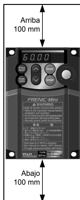
Fig. 2-2-1 Dirección del montaje y separación requerida
