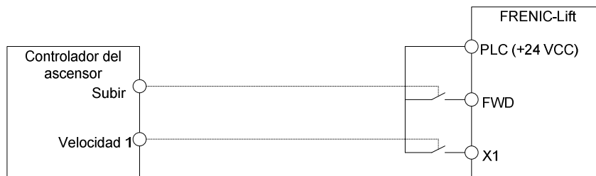
Figura 6: Conexión típica utilizando contactos libres de potencial del controlador del ascensor.
