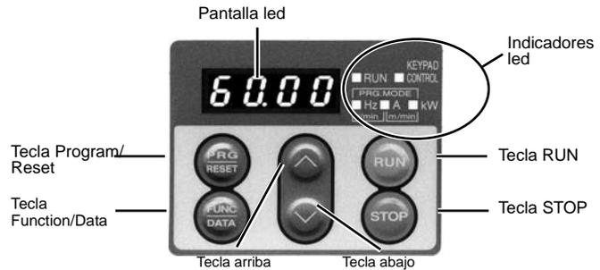
Los modos del teclado son tres: modo programación, modo funcionamiento y modo alarma.
