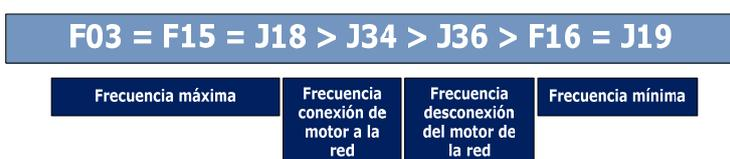
La siguiente tabla (tabla 4.2) muestra los parámetros específicos para realizar el control multibomba-regulada con 2/3 bombas reguladas:
