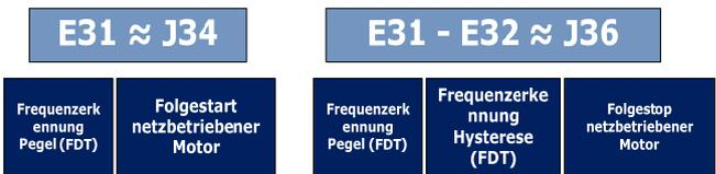
Bei dieser Steuerungsart muss möglicherweise die Abschaltzeit des Motors vom Netz verlängert werden (J37), um zu verhindern, dass die Zusatzpumpe und die Hilfspumpe gleichzeitig abgeschaltet werden. Das heißt: Die erste Pumpe, die abgeschaltet wird, sollte die Zusatzpumpe sein, danach die Hilfspumpe, aber niemals beide gleichzeitig.
