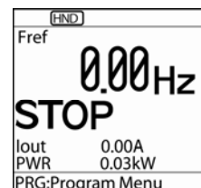
Abbildung 4.2 LED-Anzeige nach der Inbetriebnahme
