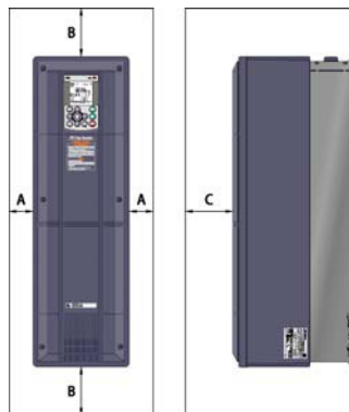
Abbildung 2.1 Montagerichtung und erforderliche Abstände
